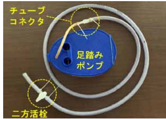
図 14 ブレードホース・コネクタ・活栓の取付け。
