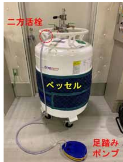
図 15 足踏みポンプとベッセルを接続した様子。
