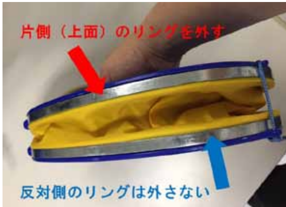
図3 ポンプ側面の金属のリング.
