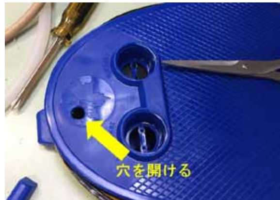
図6 ポンプ上面にドリルで開けた穴.
