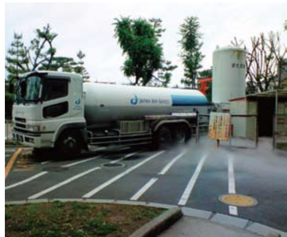
図1 タンクローリーから貯蔵タンクへ液体窒素充填の様子
